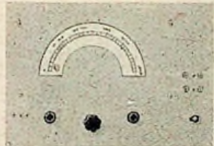
Schwingungsummer 30 ... 20000 Hz Ausgangsleistung 2 Watt
