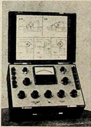
Kabelmeßgerät für Isolations-, Kapazitäts-, Leitungswiderstands- und Fehlerortsmessung
